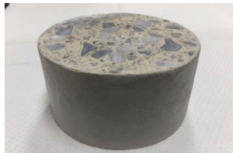
写真-1 パテ塗布後の供試体
