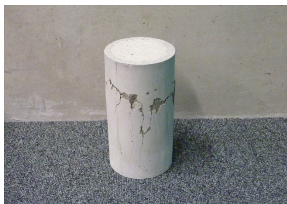
写真 1 中心圧縮実験後の供試体
