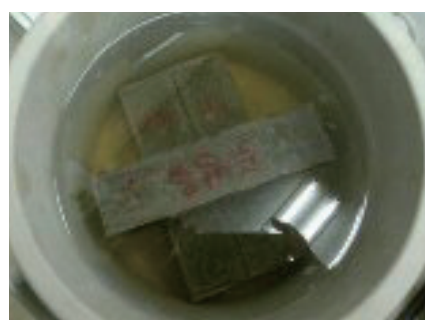
図-1 養生水の着色状況
