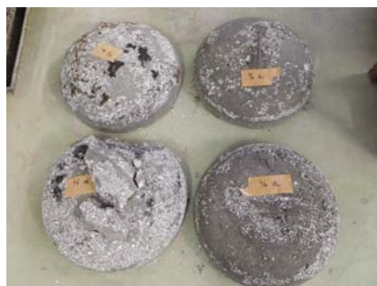
(b) 流動砂を主としたもの 写真-6 作製された藻礁基盤材
