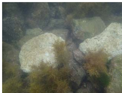
(b) 2カ月経過後に壊れた藻礁基盤材
