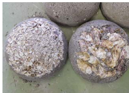
写真-8 カキ殻を活用した、陶磁器破砕片を主とした藻礁基盤材
