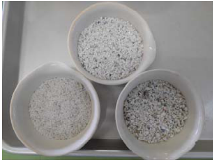
写真-2 様々な大きさの陶磁器破碎片 (粒径; 左下: 0.9mm, 右下: 2.0-4.0mm)
