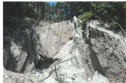
写真3 溪流No.4のシラス斜面崩壊状況（曾於市大隅町） （鹿児島大学酒匂撮影）
