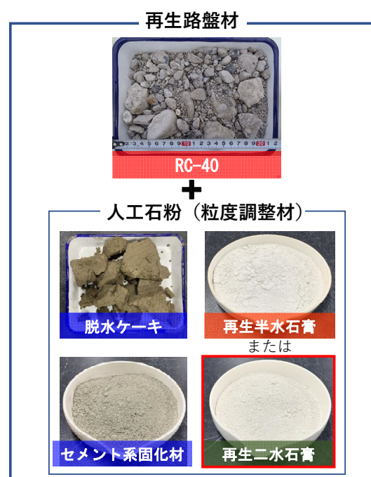
図1 再生路盤材の定義
