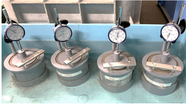
写真1 吸水膨張試験(膨張量の測定)の様子
