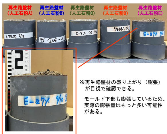
写真2 浸漬試験終了後(4ヶ月後)の供試体の様子
