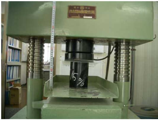
写真－８ 圧縮試験（負荷前）
