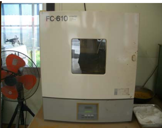
電熱炉（アスファルト加熱用）
