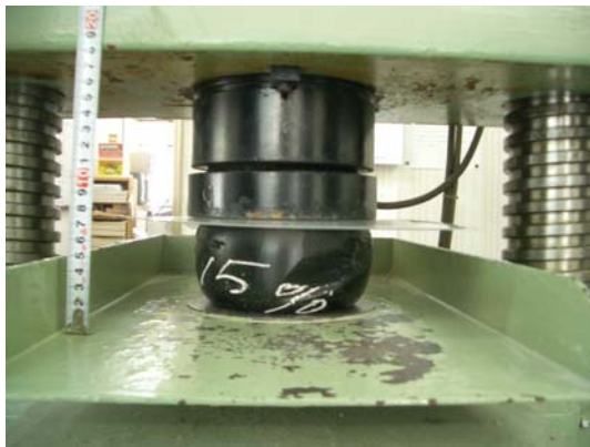
写真－９ 圧縮試験（負荷後）
