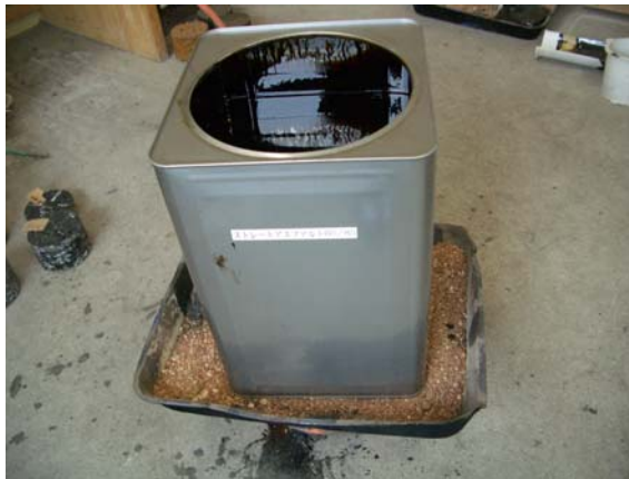
試験用アスファルト加熱（110 度以上）
