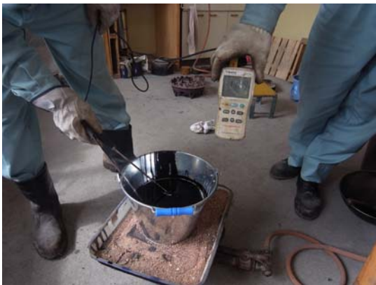
写真－2 アスファルト加熱状況
