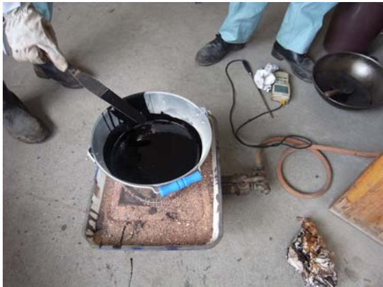
混合終了後のアスファルト
