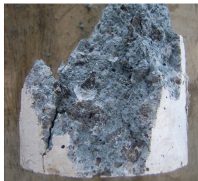
写真-1 静的圧縮試験による SSC の破断面
