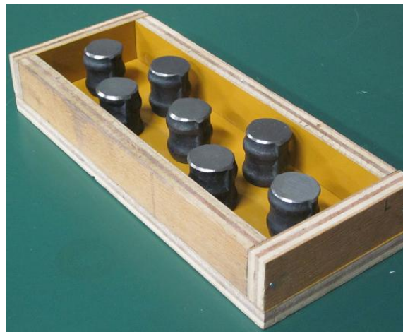
図4 初期ひび割れ発生実験用型枠
