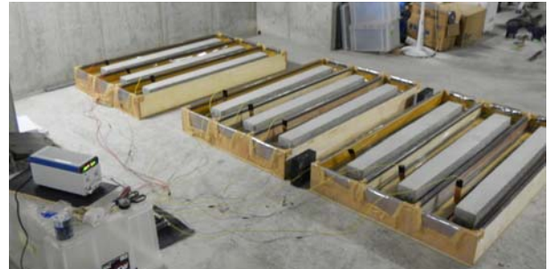
写真-1 電食の様子
