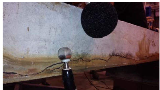
写真-2 回転式打音法の概要
