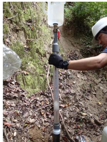
写真-4 現場透水試験の状況
