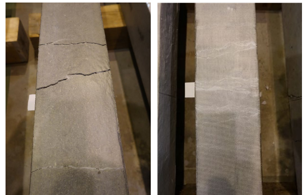
(a) 樹脂塗布 (b) 樹脂+クロスシート 写真-4 底面の破壊状況写真
