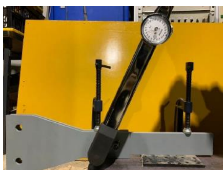
図 9 供試体の組み立ての様子 (トルクレンチによるボルト締付け)
