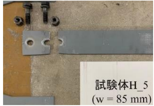
(d) 破断部位拡大 (供試体 H_5)
