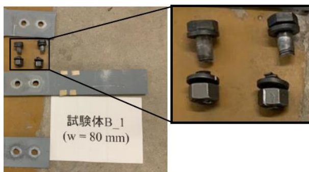
(b) ボルト破断部位拡大 (供試体 B_1)
