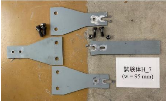
(e) 端抜け破断 (供試体 H_7)
