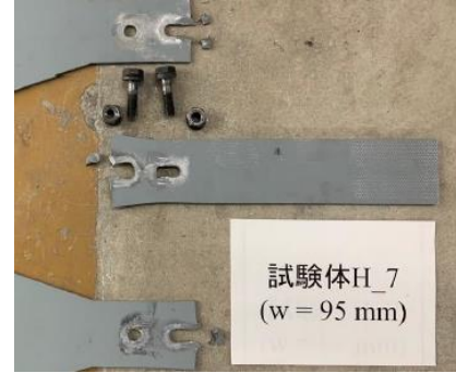
(f) 破断部位拡大 (供試体 H_7)
